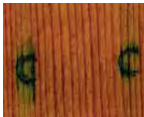
Ohne Einsatz von Pflegemilch: Durch Mikrorisse dringt Wasser ein und es entsteht Bläue.
